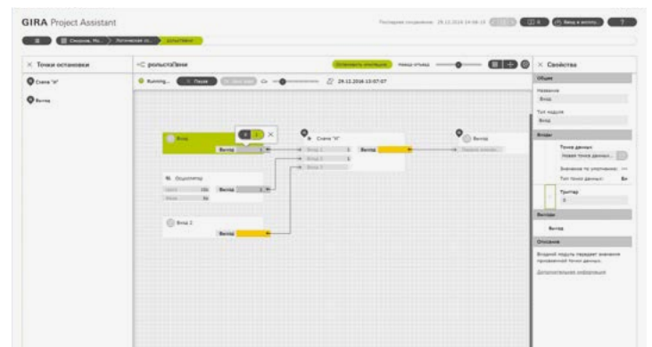
6. Проверка логики: функция симуляции в GPA позволяет заранее смоделировать и проверять функции созданной логики: это существенно ускорит ввод в эксплуатацию.
