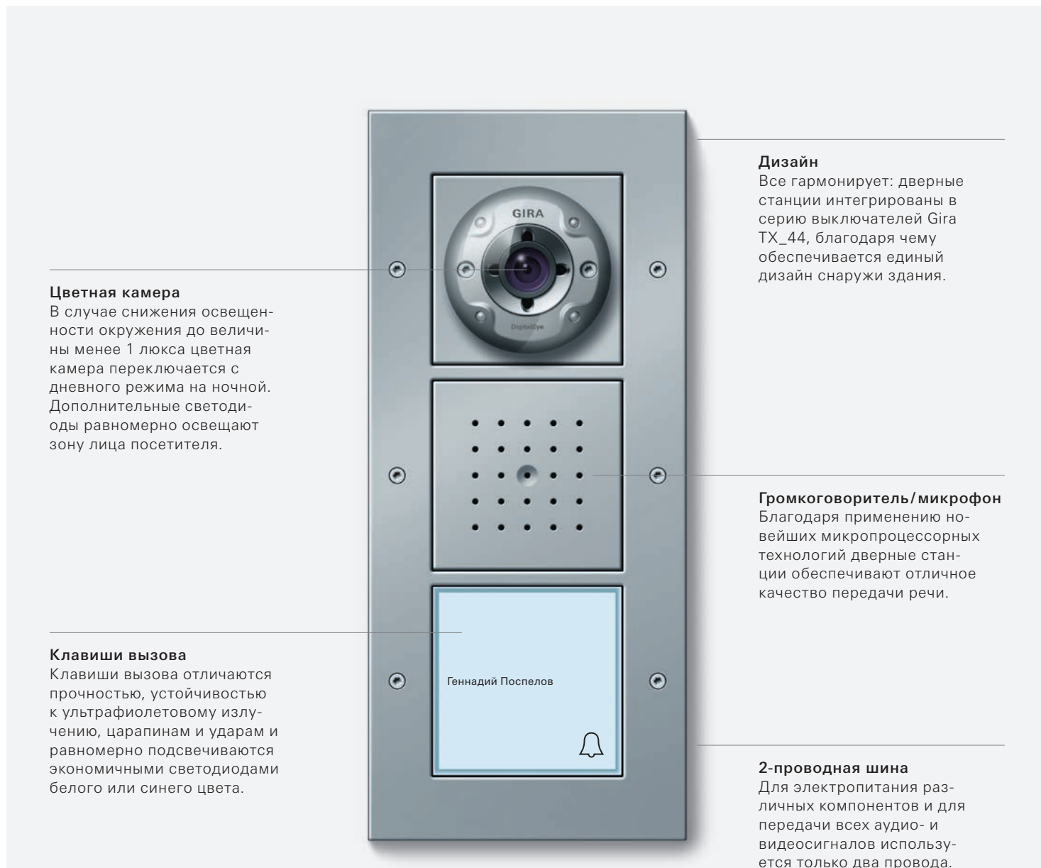
Рис.: Дверная видеостанция накладного монтажа Gira с 1-клавишной секцией вызова, "алюминий"
