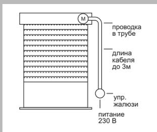
Подключение скатывающего устройства с шнуровым выключателем
