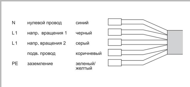
Подключение скатывающего устройства с шнуровым выключателем
